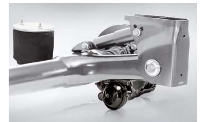
W korpusie osi zespolone są wahacze wzdłużne, rura osi, kołnierze hamulców i czopy osi
